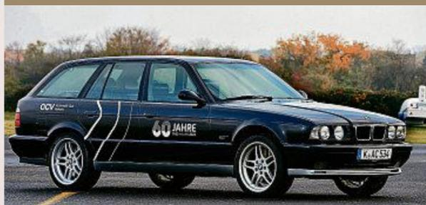
Seltener Power-Kombi mit Einzeldrosselklappen und Nürburgringpaket. Der Motor S38B38 entstammt dem legendären BMW M1. Fertigung zum Großteil in Handarbeit.
