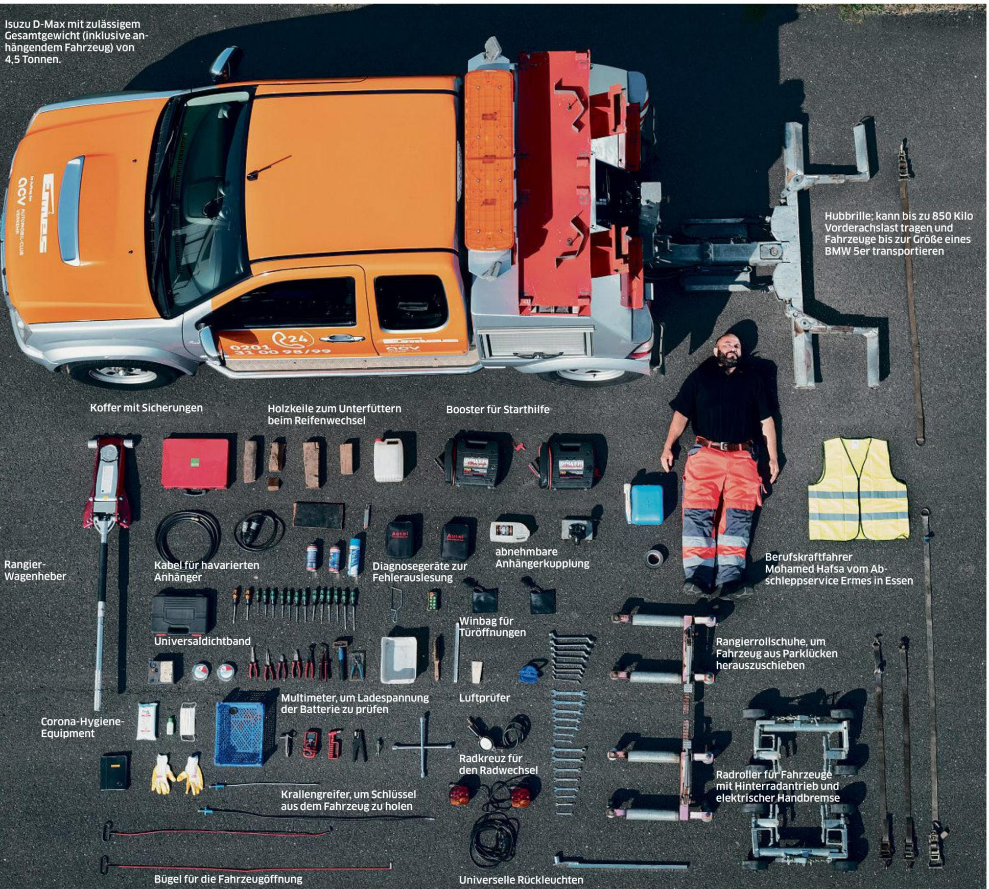
Hubbrille: kann bis zu 850 Kilo Vorderachslast tragen und Fahrzeuge bis zur Größe eines BMW 5er transportieren
